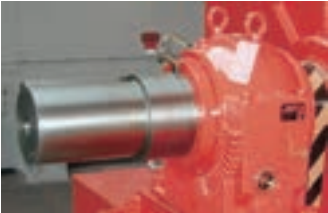
Cojinete deslizante con anillo de lubricación, autor-refrigerado, de construcción aislada con escobilla de puesta a tierra
