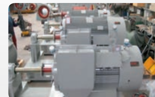
Planta química - Motor asíncrono de jaula de ardilla en Ex de IIB T3, 265 kW, 6 kV, 6 polos - Motores asíncronos de jaula de ardilla en Ex de IIB T3, 480 kW, 6 kV, 8 polos
